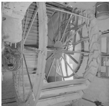
Moulin : la roue située à l'intérieur et actionnée par l'eau du canal. Phot. Eric Dessert IVR82_20002600721X
