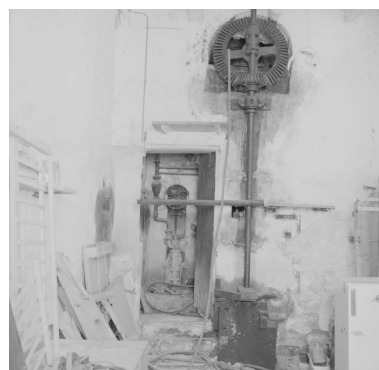
Ancien essieu en partie démonté, situé dans les ateliers du moulinage.
