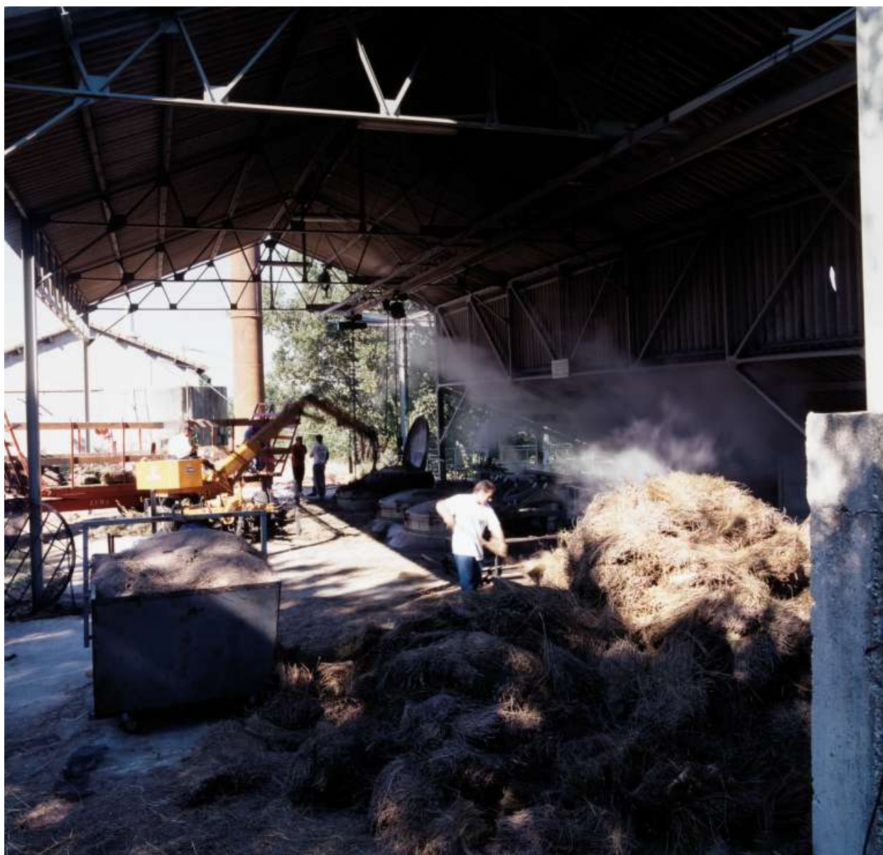
Distillerie en activité. Les bottes vont être déposées dans les cuves à vapeur, afin d'obtenir de l'essence de lavandin.
