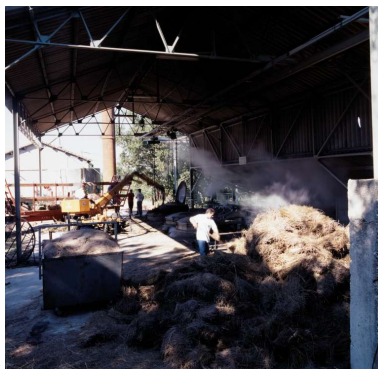
Distillerie en activité. Les bottes vont être déposées dans les cuves à vapeur, afin d'obtenir de l'essence de lavandin. Phot. Eric Dessert IVR82_20002600812XA
